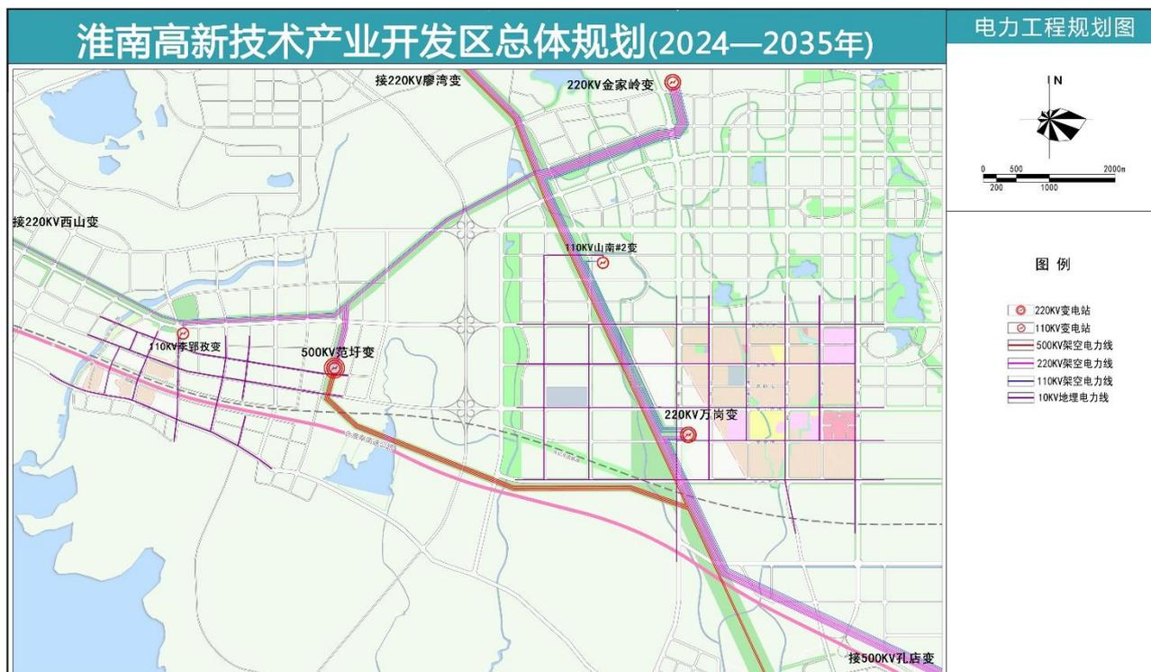
图 2.2.6-4 电力工程规划图
