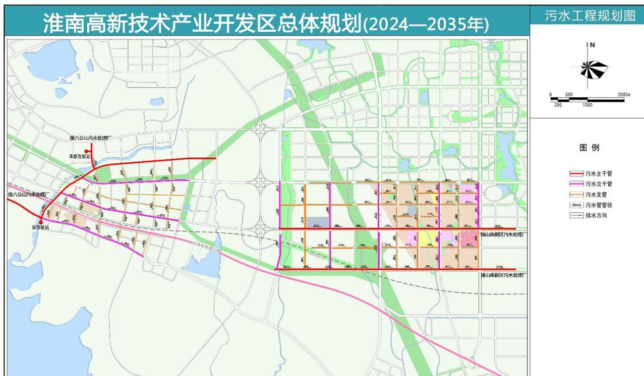
图 2.2.6-2 污水工程规划图
